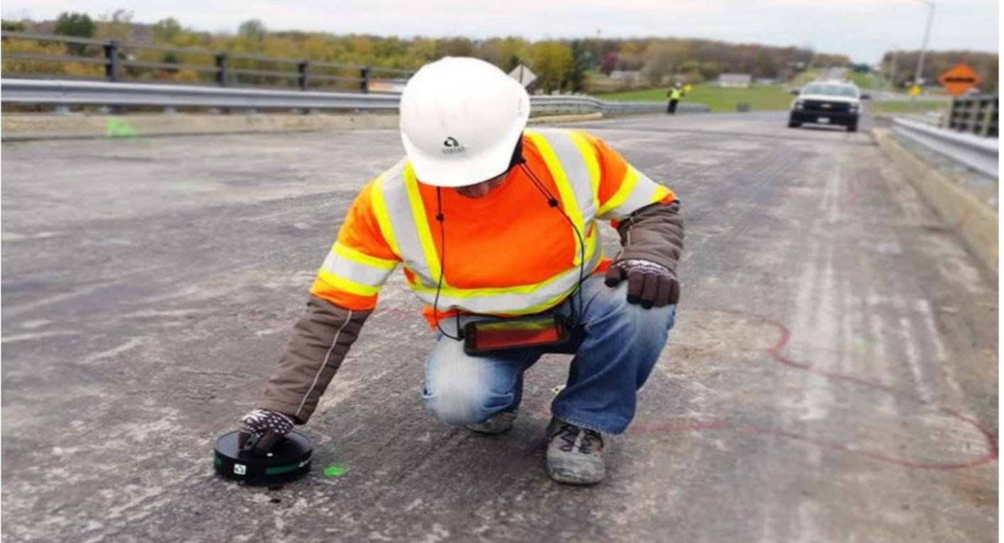
**iCOR** proposé par Macben est un nouvel outil compact et complet de contrôle non destructif pour l'évaluation détaillée de la corrosion des structures en béton armé. Il n'est pas nécessaire d'avoir une connexion électrique avec l'armature. Il est équipé de capteurs de haute précision pour mesurer le taux de corrosion des barres d'armatures, résistivité électrique du béton, ainsi que la température ambiante et l'humidité.
