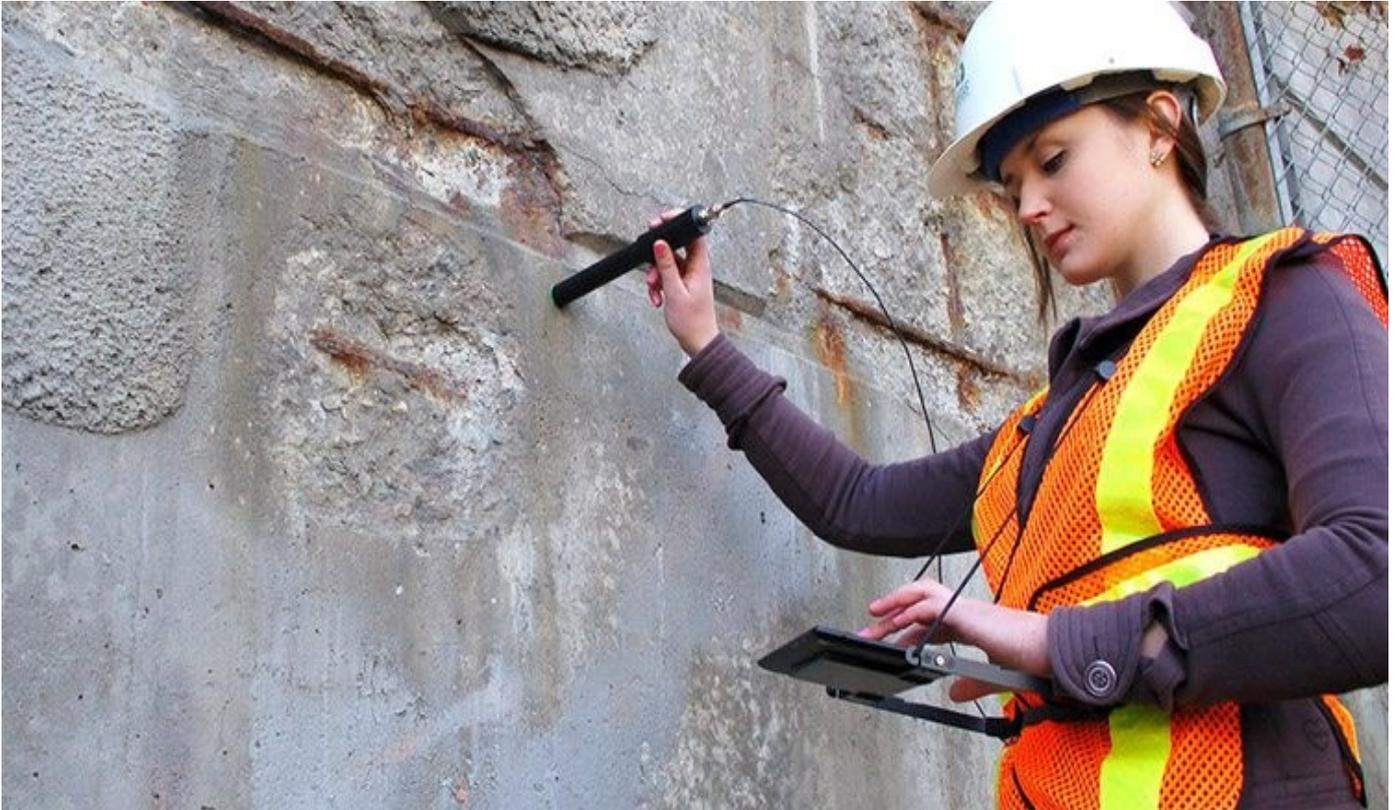
Cell™ est une nouvelle sonde CND (selon la norme ASTM C876), fonctionnant sur tablette/téléphone pour une détection rapide, précise et efficace de la corrosion dans les structures en béton armé,
