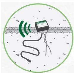
SmartRock2 est un capteur sans fil, robuste et imperméable à l'eau qui permet de contrôler la température et la maturité du béton en temps réel. Le capteur est placé dans le coffrage du béton (installé sur l'armature) avant de verser le béton. L'utilisation de SmartRock2 app pour contrôler la maturité du béton et partager des données est facile et rapide.
