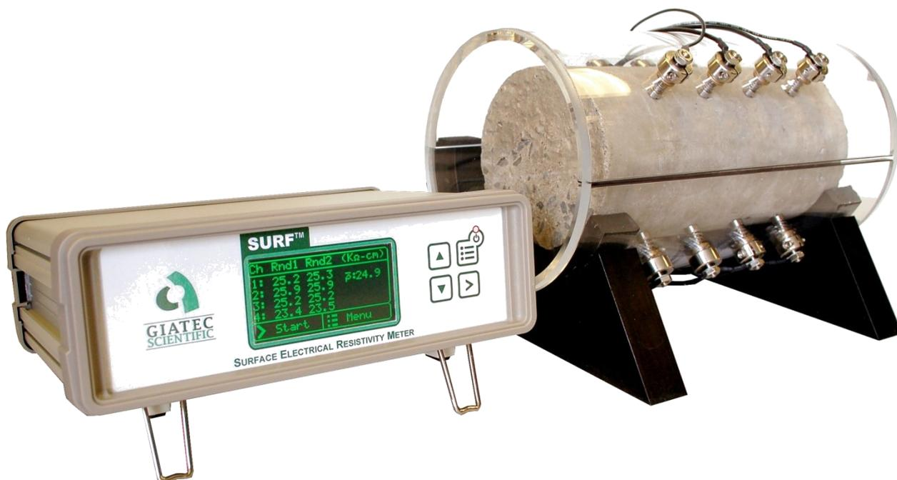
Giatec Surf™ est un appareil de test de laboratoire permettant de mesurer rapidement, facilement et précisément la résistivité électrique de la surface du béton, basé sur la technique des quatre sondes (Wenner-Array) conformément à AASHTO TP 95-11, et ASTM. Surf™ dispose d'une configuration unique et sur mesure, qui permet de mesurer la résistivité électrique avec une grande précision en réduisant la durée du test et en minimisant les influences de l'environnement.
