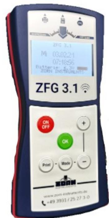
ZFG 3.1 Déflectomètre léger selon la norme ASTM E2835-11 et TP BF-StB partie B 8.3, étalonné selon TP BF-StB partie B 8.4.
